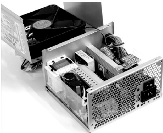
Obrázek 1: Vnitřek počítačového ATX zdroje. Zřetelně je vidět 120 mm ventilátor, který chladí všechny součástky uvnitř, a 2 hliníkové chladiče, mezi ostatními součástkami.
